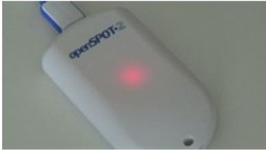
Eine kurze gelbe LED während der Übertragung signalisiert eine ungültige Paketfolgenummer empfangen wird (was bedeutet, Netzwerkpaketverlust).
