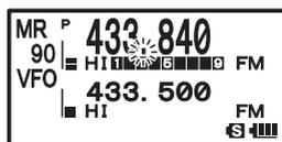
Wenn das Funkgerät ein Signal über die Frequenz empfängt, die im Prioritätsspeicherkanal [90] registriert ist, stoppt der Dualempfang und der Signalempfang wechselt zu [90] (Standby).
